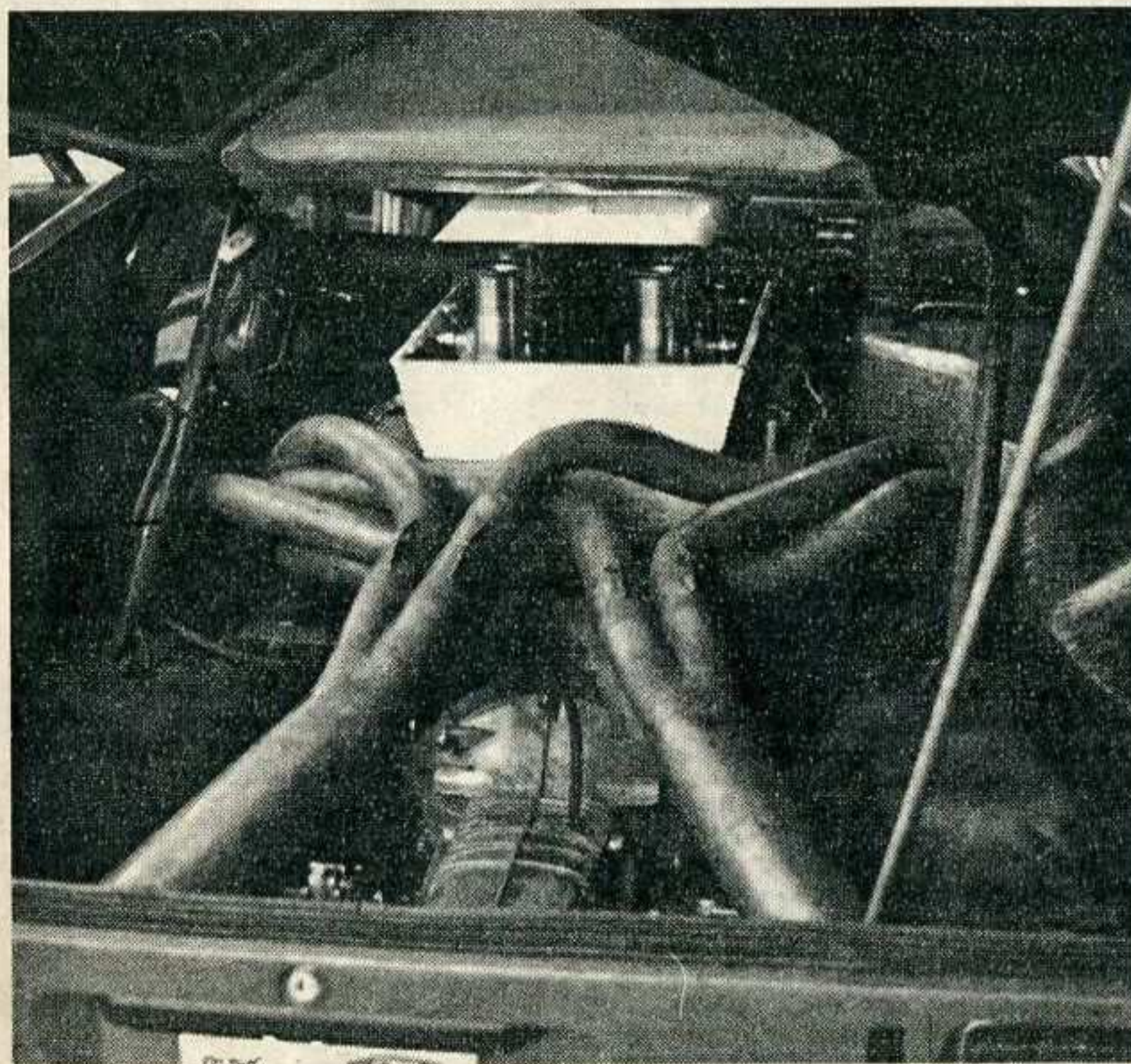
Sopra, Mario Casoni a Misano mentre prova la De Tomaso Pantera gruppo 4 in edizione rinnovata. Sotto, l'8 cilindri Ford è dotato di carter secco. Diversi anche i carburatori e ritoccato il cambio
