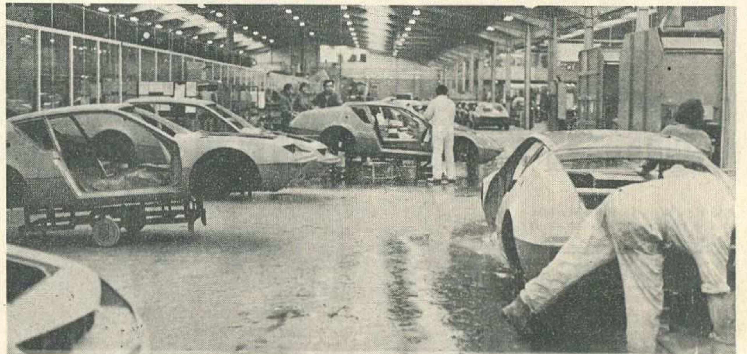
Questo è il reparto costruzione carrozzerie. Oggi parte delle carrozzerie Alpine è in fibra di vetro, assemblata su telaietti metallici e poi incollata alle altre parti. Si tratta di un procedimento molto lungo e costoso, ma dai risultati eccellenti per quanto riguarda il risparmio sul peso
