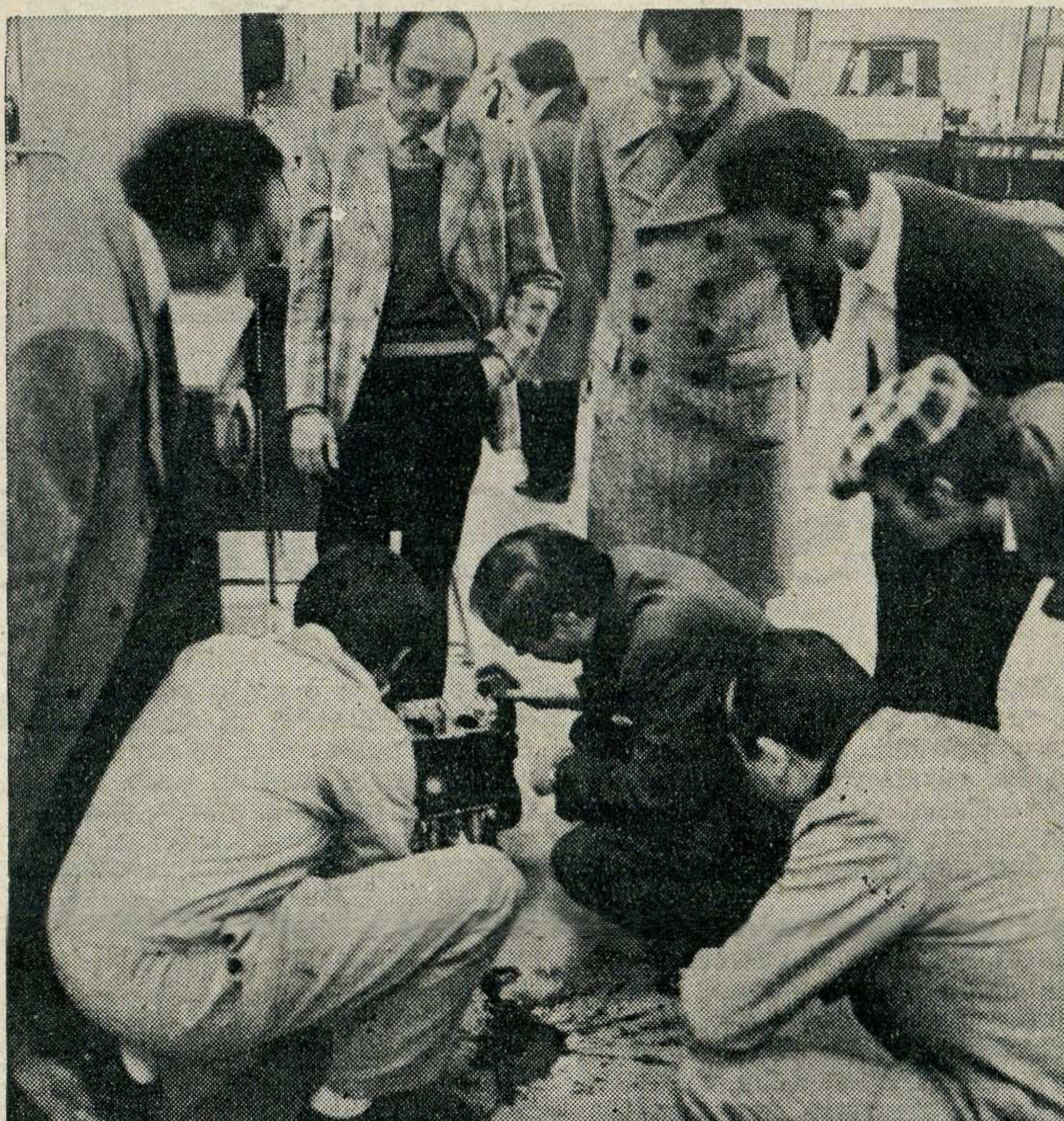
Russo e Avidano controllano la testa del motore della macchina di Paganelli cui si è spalata la filettatura di una candela. La testa verrà sostituita con una nuova con una operazione a tempo di record
