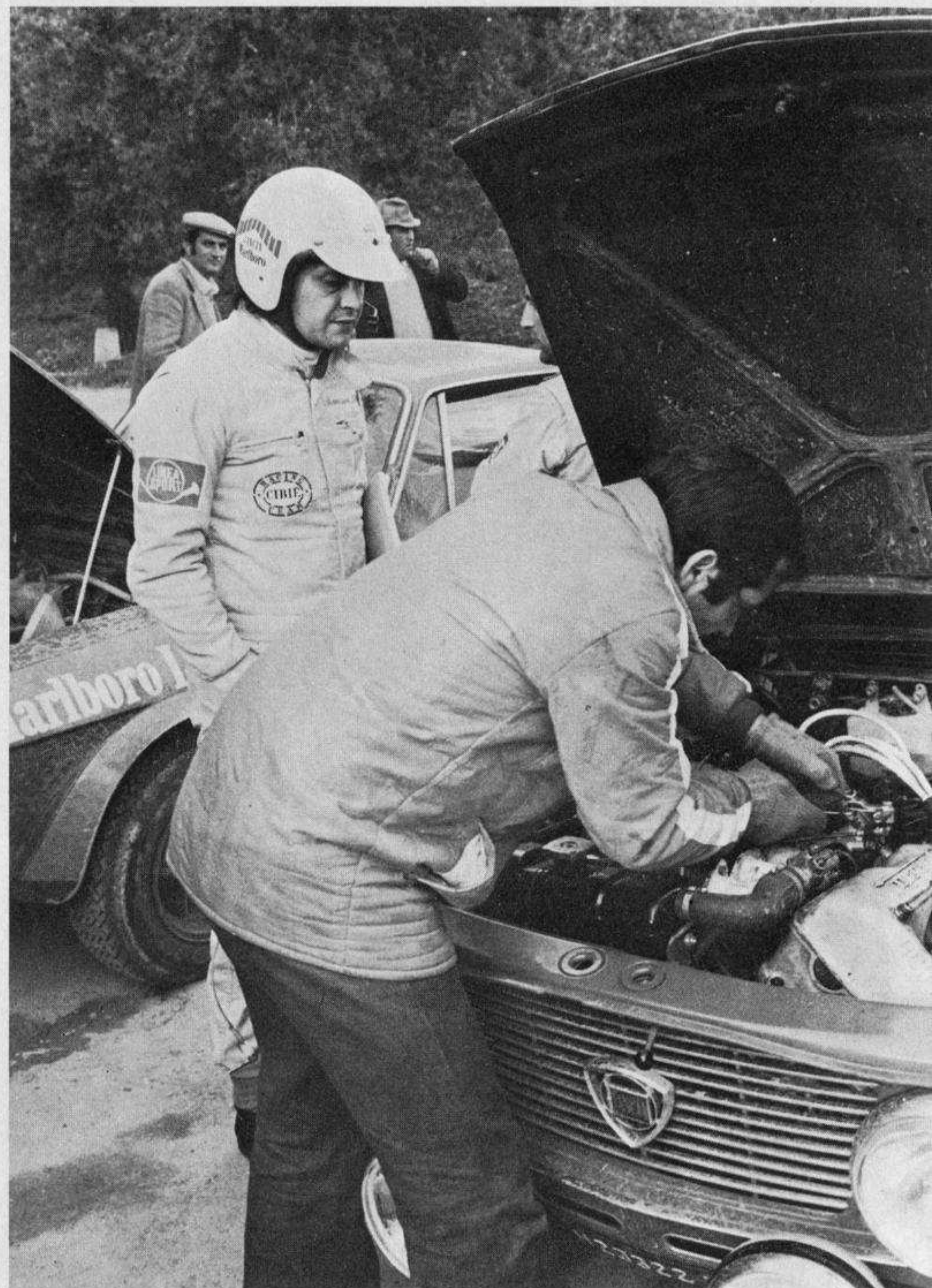
La tiranteria dell'acceleratore ha dato diversi fastidi alle Fulvia in gara. Nella foto sopra vediamo il capomeccanico Podda mentre la sta registrando sotto lo sguardo vigile e preoccupato di Mannucci. Non meno preoccupato, Brai (foto sotto) cui non doveva sembrar vero di riuscire a finire il Rally in quinta posizione
