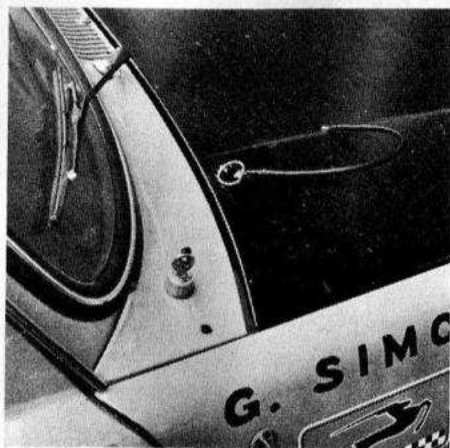
Altre soluzioni di Maglioli. A sinistra, sopra, un gancio fermacofano di estrema sicurezza e l'interruttore staccabatteria identico a quelli montati sulle Fulvia ufficiali. Sempre sopra, a destra, i particolari del gancio fermacofano. Sotto, la slitta in « avional » lunga quanto la vettura, appositamente studiata per proteggere la parte inferiore
