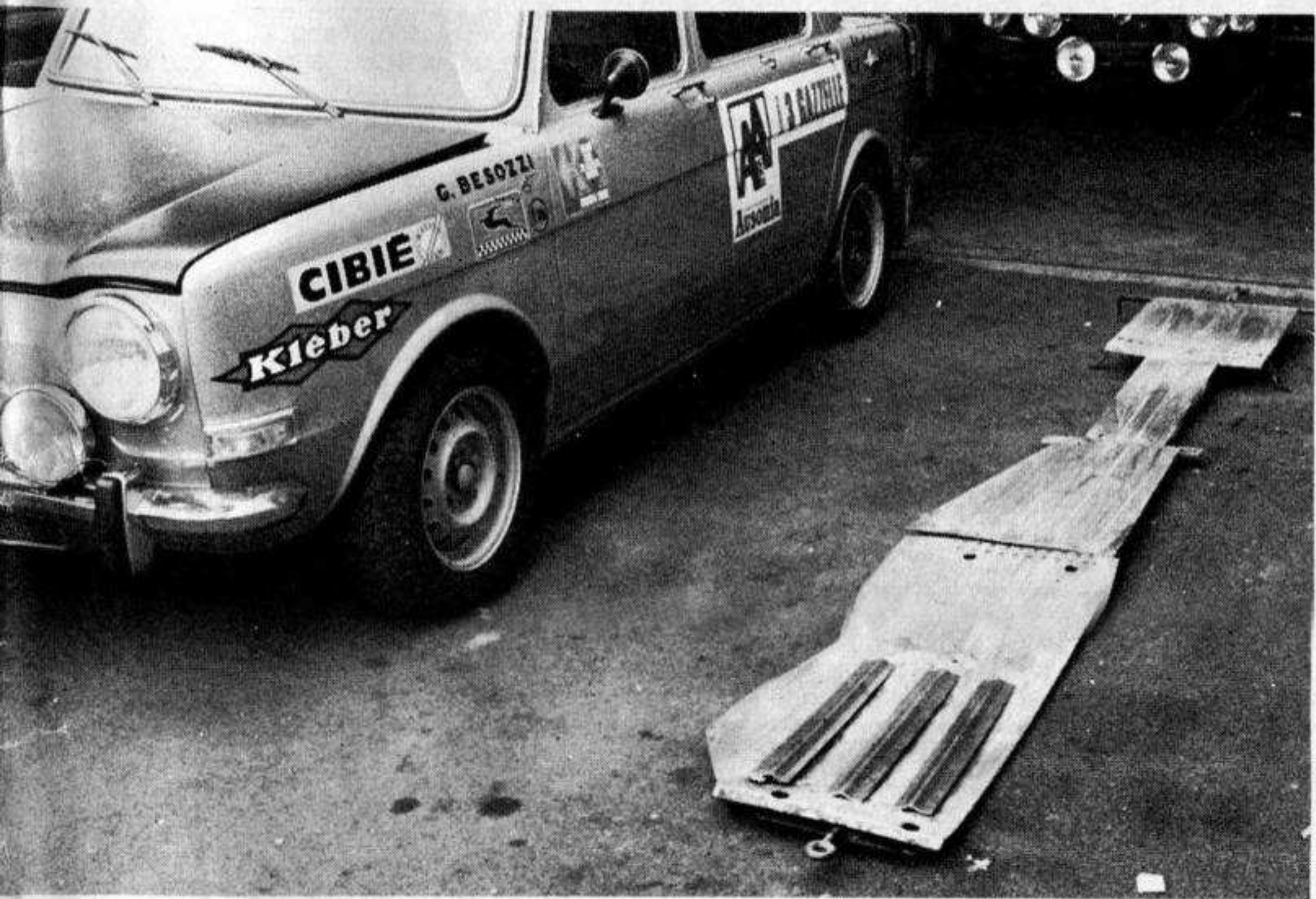
Altre soluzioni di Maglioli. A sinistra, sopra, un gancio fermacofano di estrema sicurezza e l'interruttore staccabatteria identico a quelli montati sulle Fulvia ufficiali. Sempre sopra, a destra, i particolari del gancio fermacofano. Sotto, la slitta in « avional » lunga quanto la vettura, appositamente studiata per proteggere la parte inferiore
