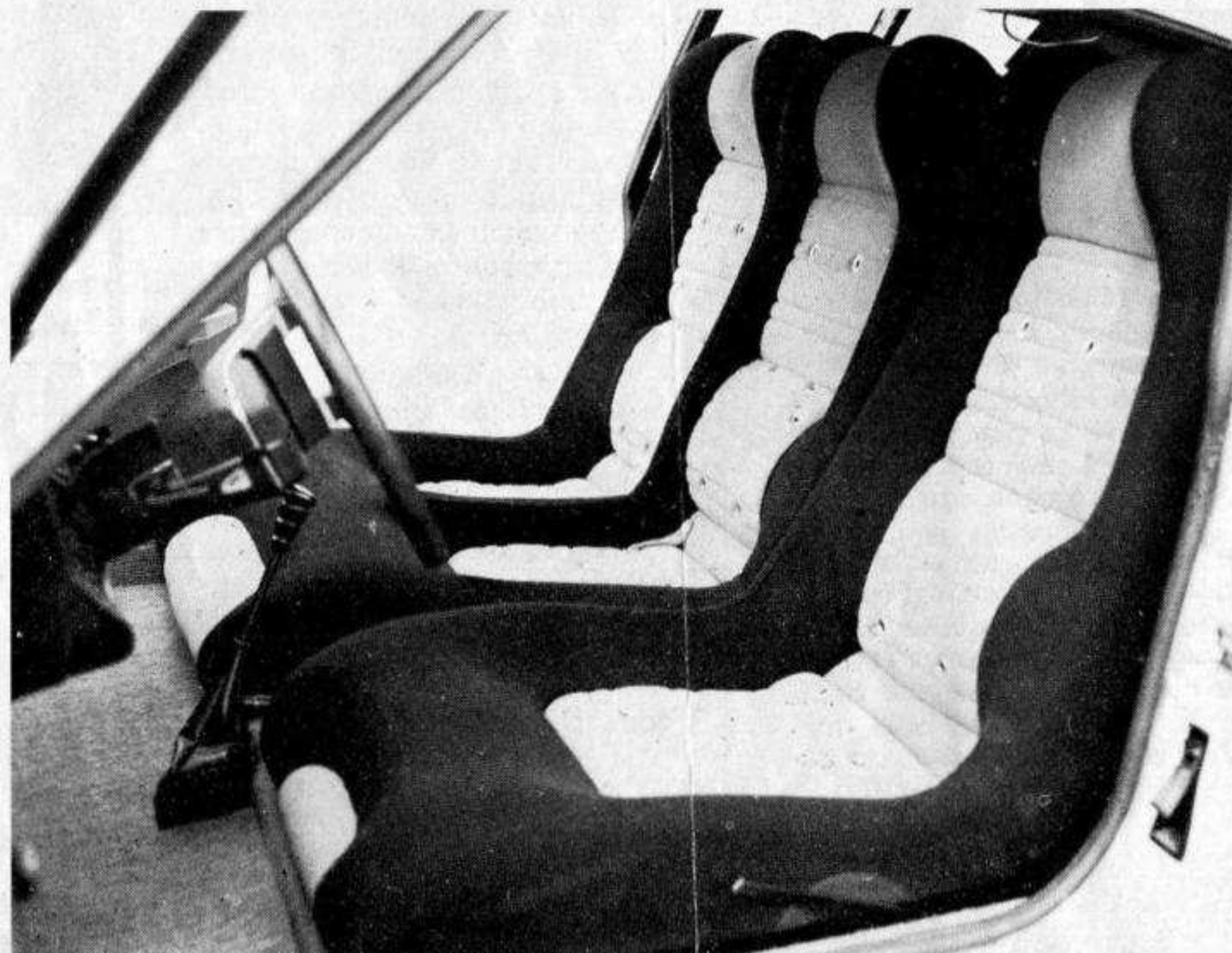
Sopra, la Bagheera è provvista di un potente impianto di illuminazione, in parte celato nelle ore diurne, che viene esposto con un sistema pneumatico. Sotto, l'abitacolo a tre posti affiancati della vettura
