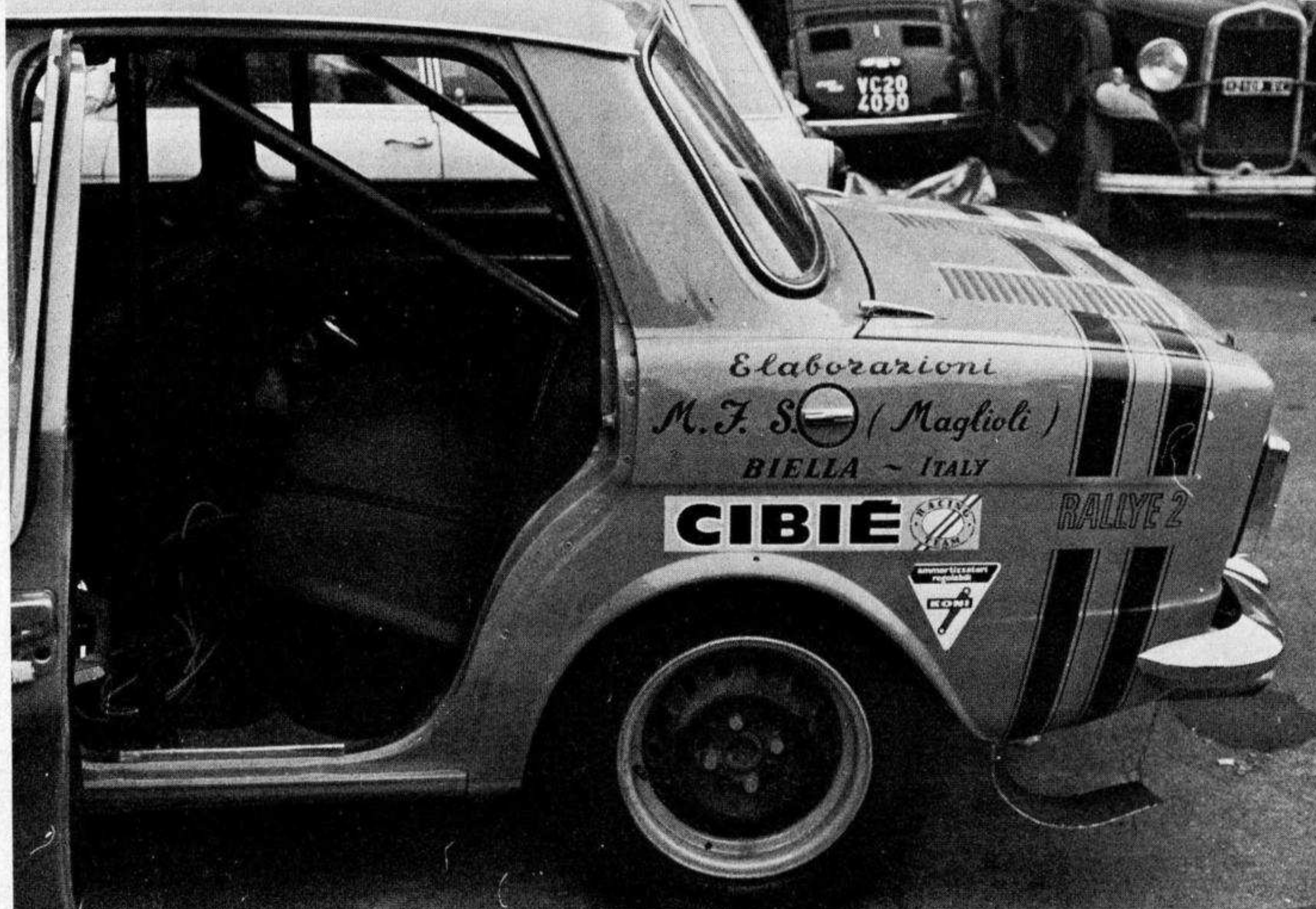
Il biellese Maglioli, preparatore ufficiale delle Simca Rally 2, ha adottato soluzioni particolari per alcuni dettagli tecnici che interessano la sicurezza. Nella foto sopra, vediamo come la centina fondando il sedile posteriore va ad attaccarsi sul longherone all'altezza delle sospensioni per cui il rollbar (foto sotto), con questo sistema di attacchi assume una chiara funzione di traliccio portante
