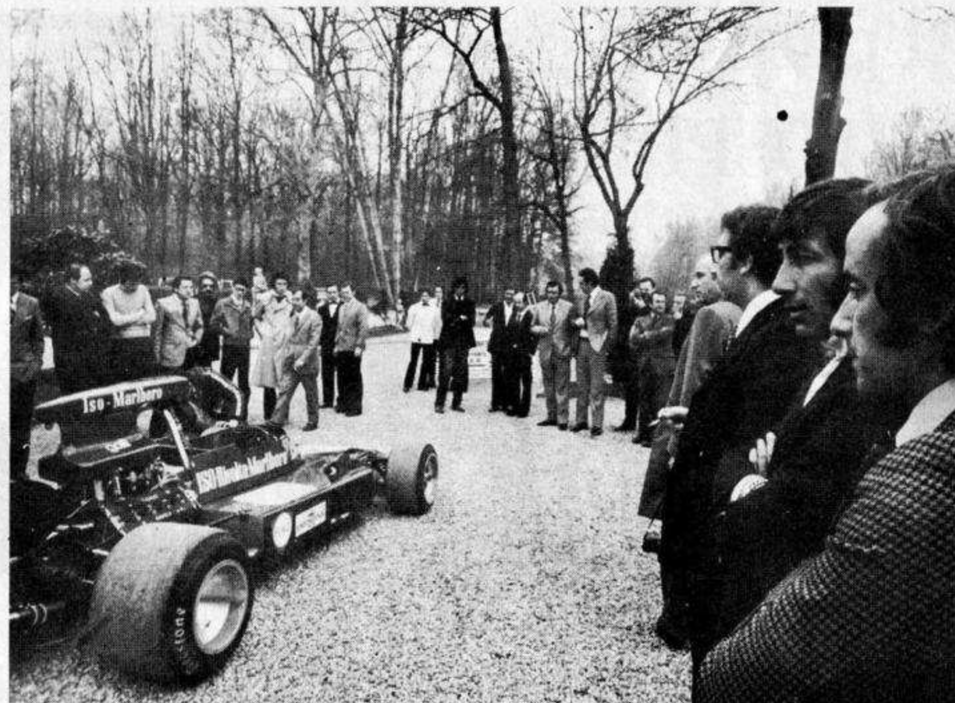
Ganley e Galli, all'estrema destra, si scambiano le prime impressioni sulla nuova F. 1. Nanni, che l'ha provata a Goodwood, dice che ha problemi di alimentazione e che l'aerodinamica è da sistemare. Di Iso-Marlboro ne esistono 2 esemplari, che saranno in Spagna
