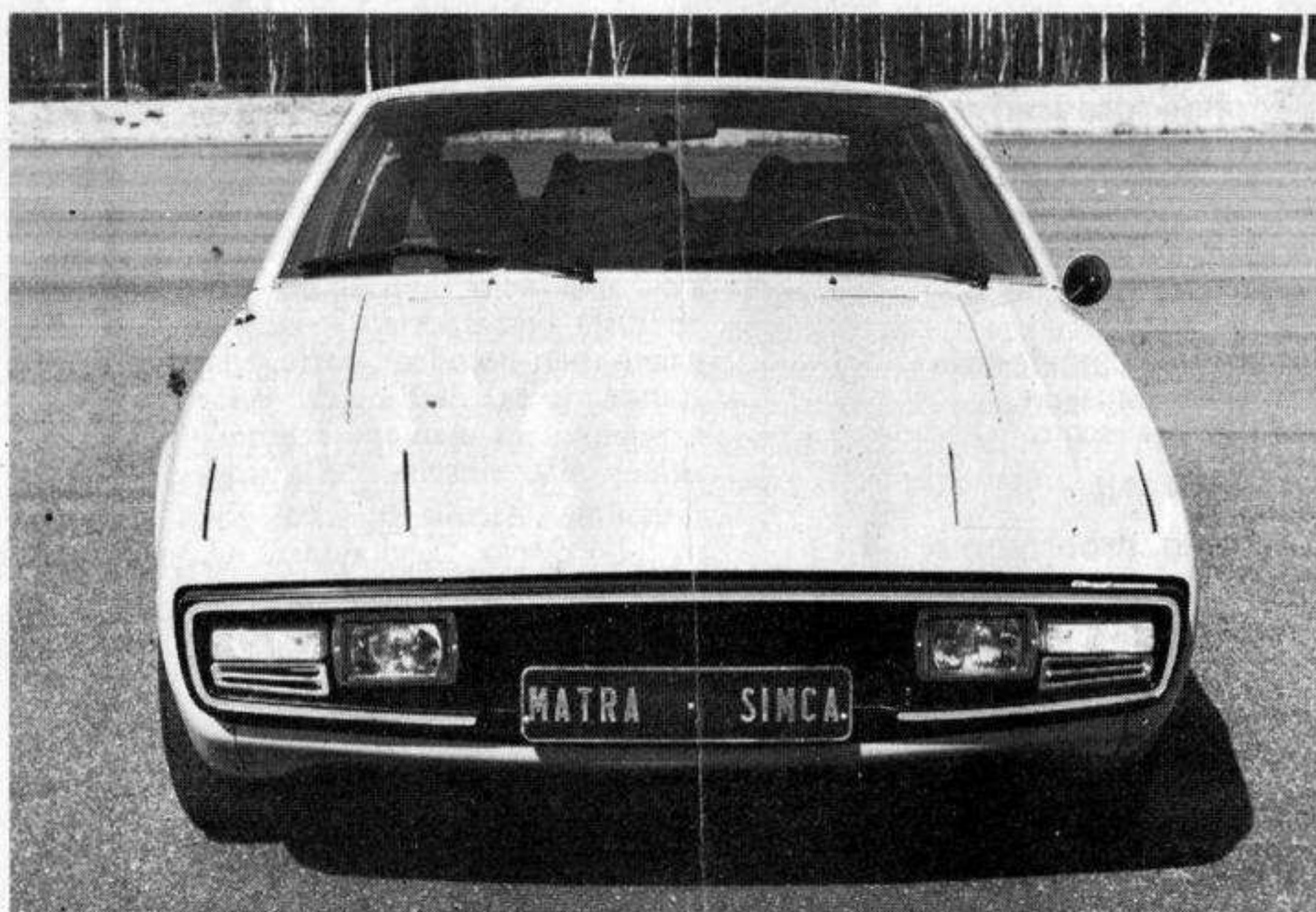
Sopra, la Bagheera è provvista di un potente impianto di illuminazione, in parte celato nelle ore diurne, che viene esposto con un sistema pneumatico. Sotto, l'abitacolo a tre posti affiancati della vettura
