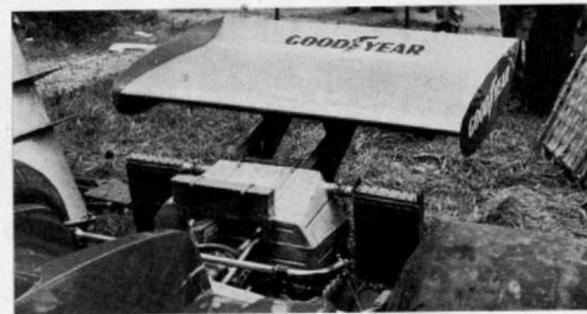
A sinistra: l'alettone della Ferrari radiatore anteriore è dotato di un solo supporto principale posto sulla parte anteriore e regolabile in altezza
