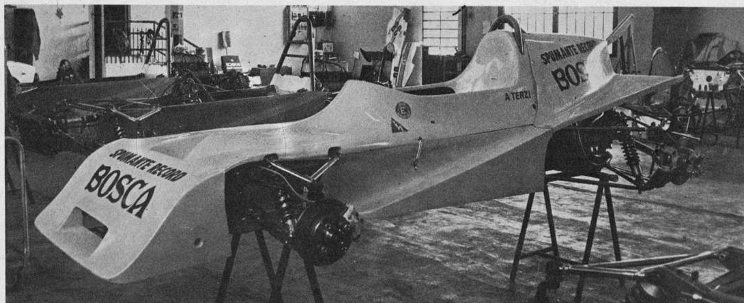
Sopra, la prima serie di Formula Ford Delta Mk.2 in costruzione. Ne sono in preparazione 15. Sotto, a sinistra la sospensione posteriore e quella anteriore sono le stesse della Lotus 69. A destra, il telaio a traliccio conserva i tubi quadri solo nel perimetro. È costruito in Gran Bretagna dalla Arch Motors
