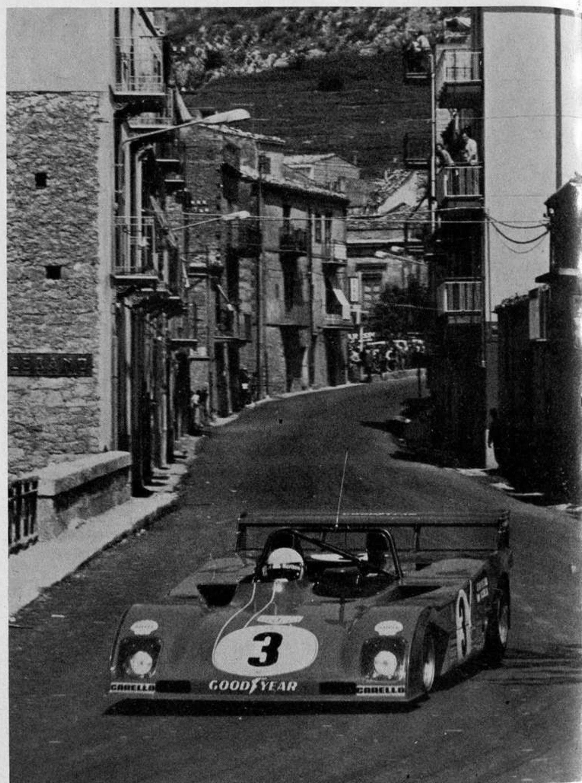
La Ferrari 312 P di Merzario attraversa Collesano. Le vetture modenesi avevano le solite modifiche tipo Targa, con ruota di scorta montata sul fianco destro e relativi attrezzi. Anche in questa vettura si nota l'antenna del sistema radio rice-trasmittente fra pilota e box
