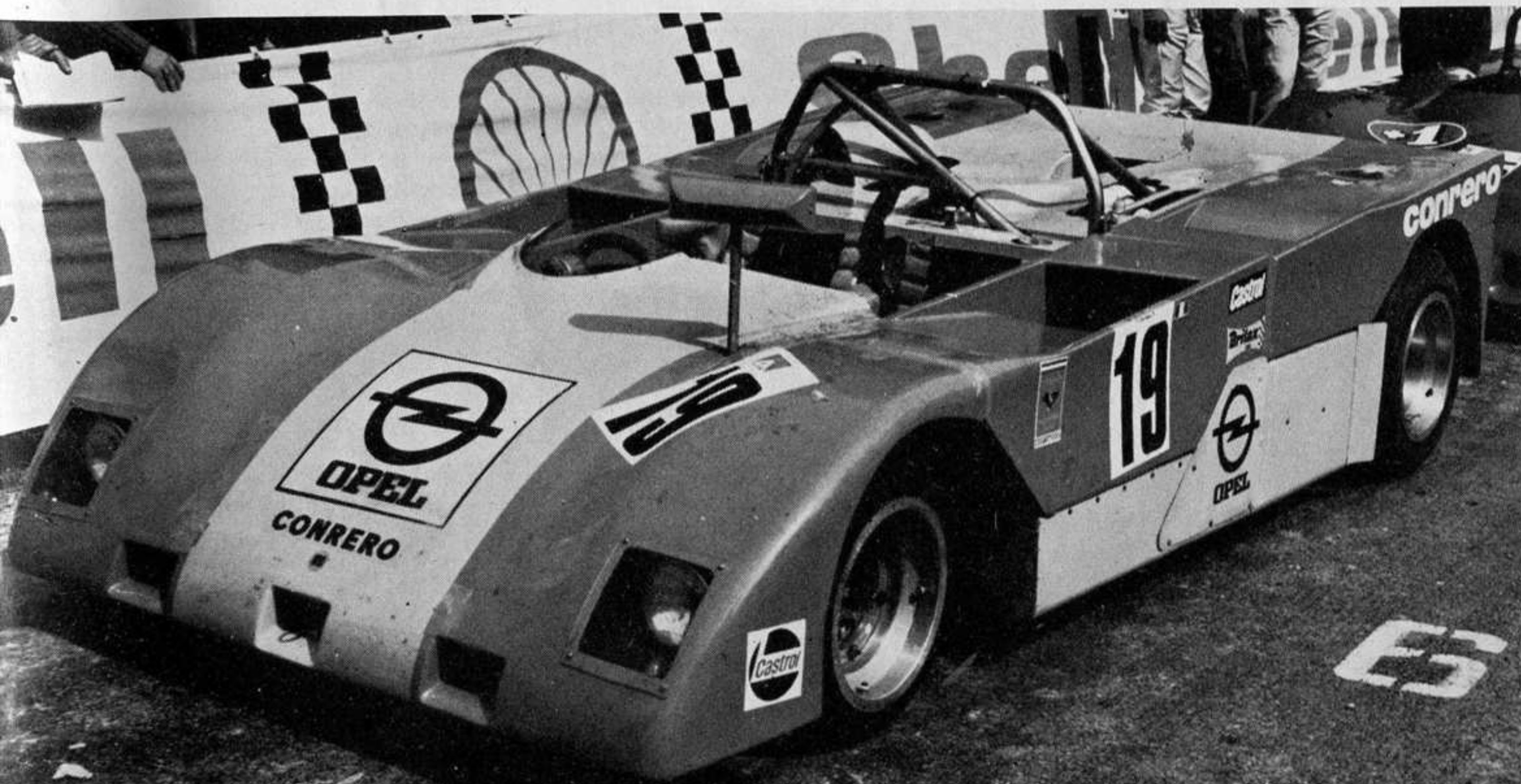
La piccola vettura dell'ing. Bizzarrini, in piena corsa. Essa è basata sul motore Fiat 128, ed è interessante soprattutto per l'impianto di scarico, che è sdoppiato ai condotti d'uscita, per formare un nodo convenzionale 4=1 più due nodi arretrati 2=1, allo scopo di garantire una buona resa ai più bassi regimi. Con materiale di serie, ha dato 108 cavalli a 8.000 giri, mentre con l'iniezione Spica e con la testa più irrobustita della X-1/9 è giunto alla quota 147 cavalli.
