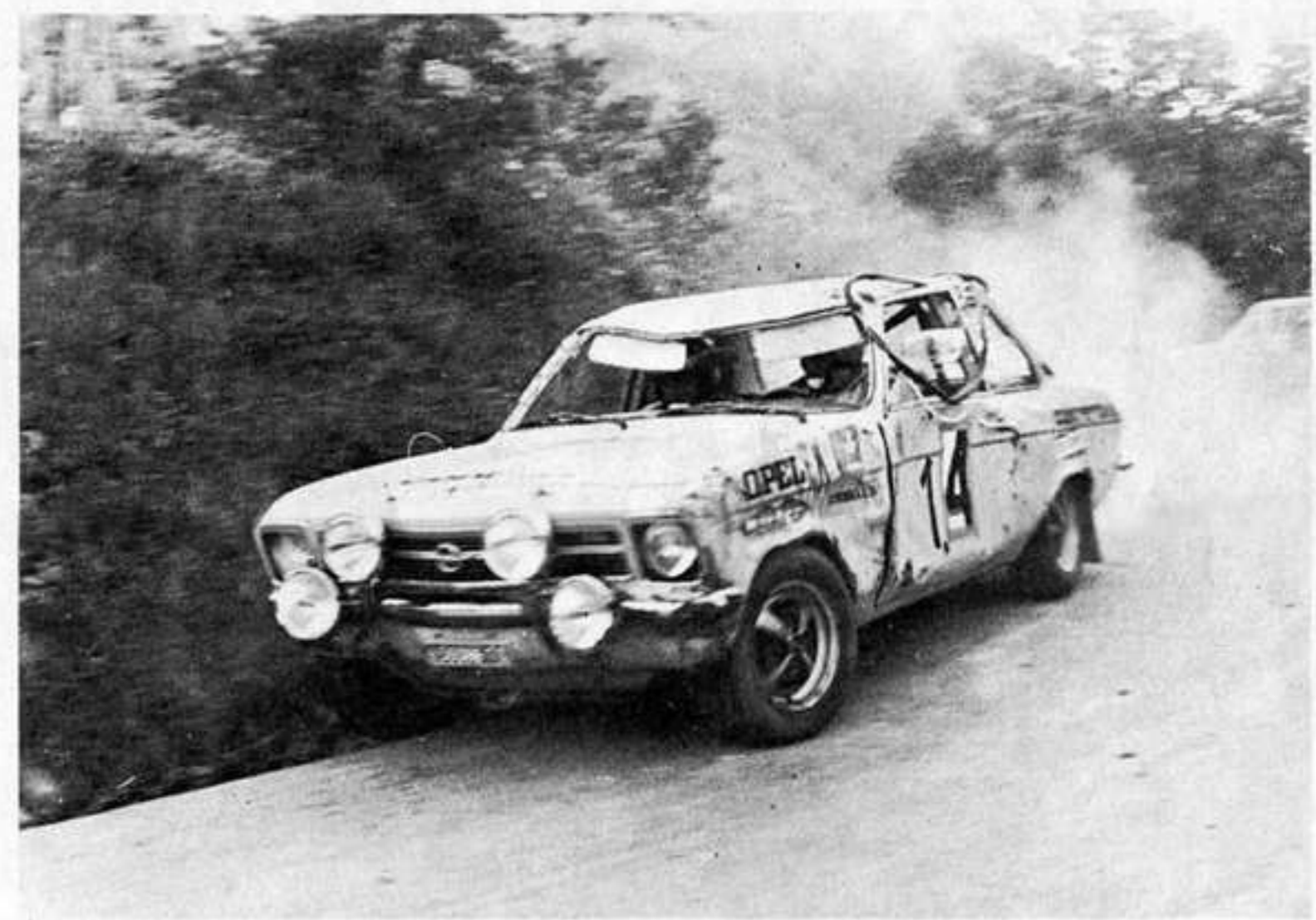
Ancora una macchina reduce da un «tonneau» fuori programma, quella di «Principe» Ninni Russo. La ragione del ritiro è stata la fusione del motore causa l'olio colato fuori mentre era a pancia in su
