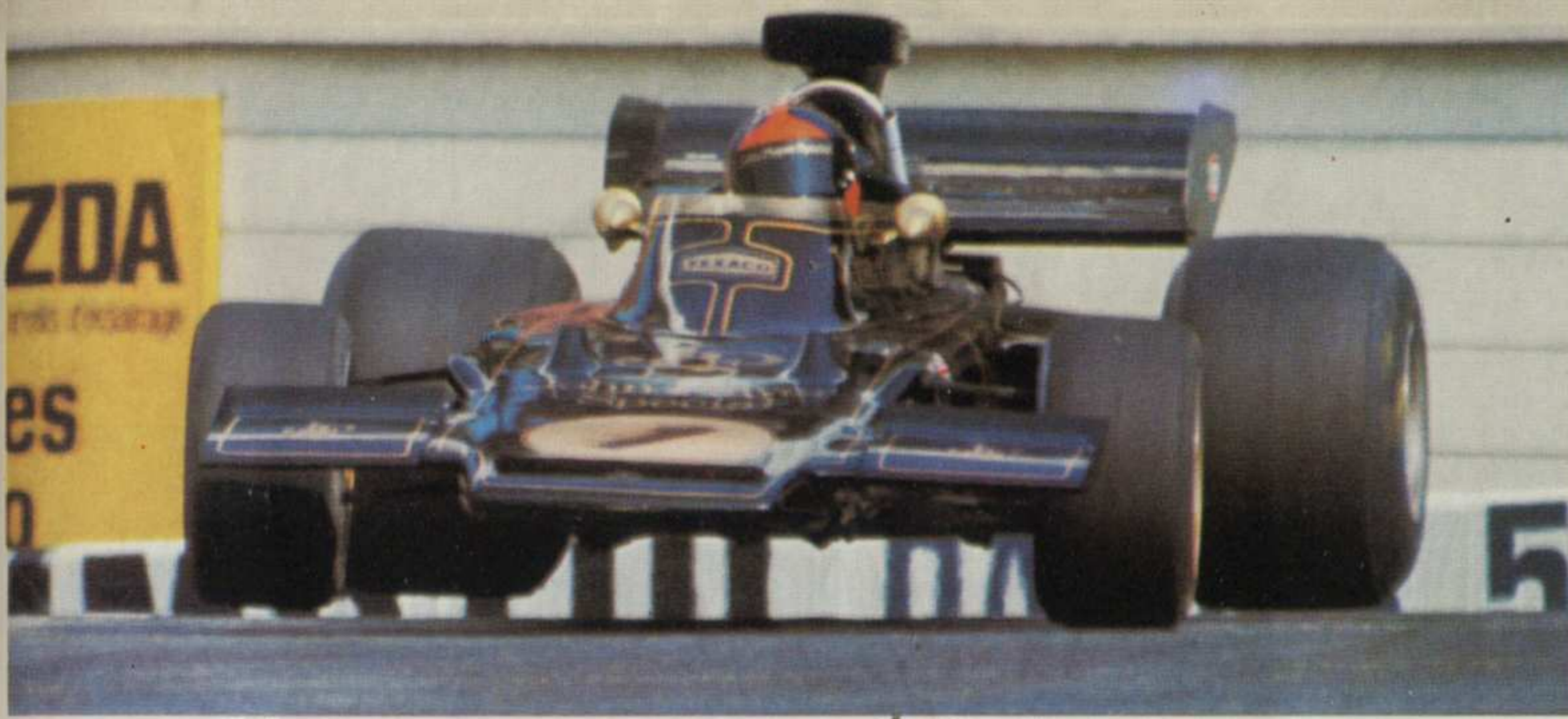
Nelle foto, esempi di lavoro. A sinistra il salto a Montecarlo ha fatto perdere aderenza alla JPS di Fittipaldi. Sotto, la BRM-Marlboro di Lauda alza molto la ruota interna: segno anche di barre di rollio molto dure
