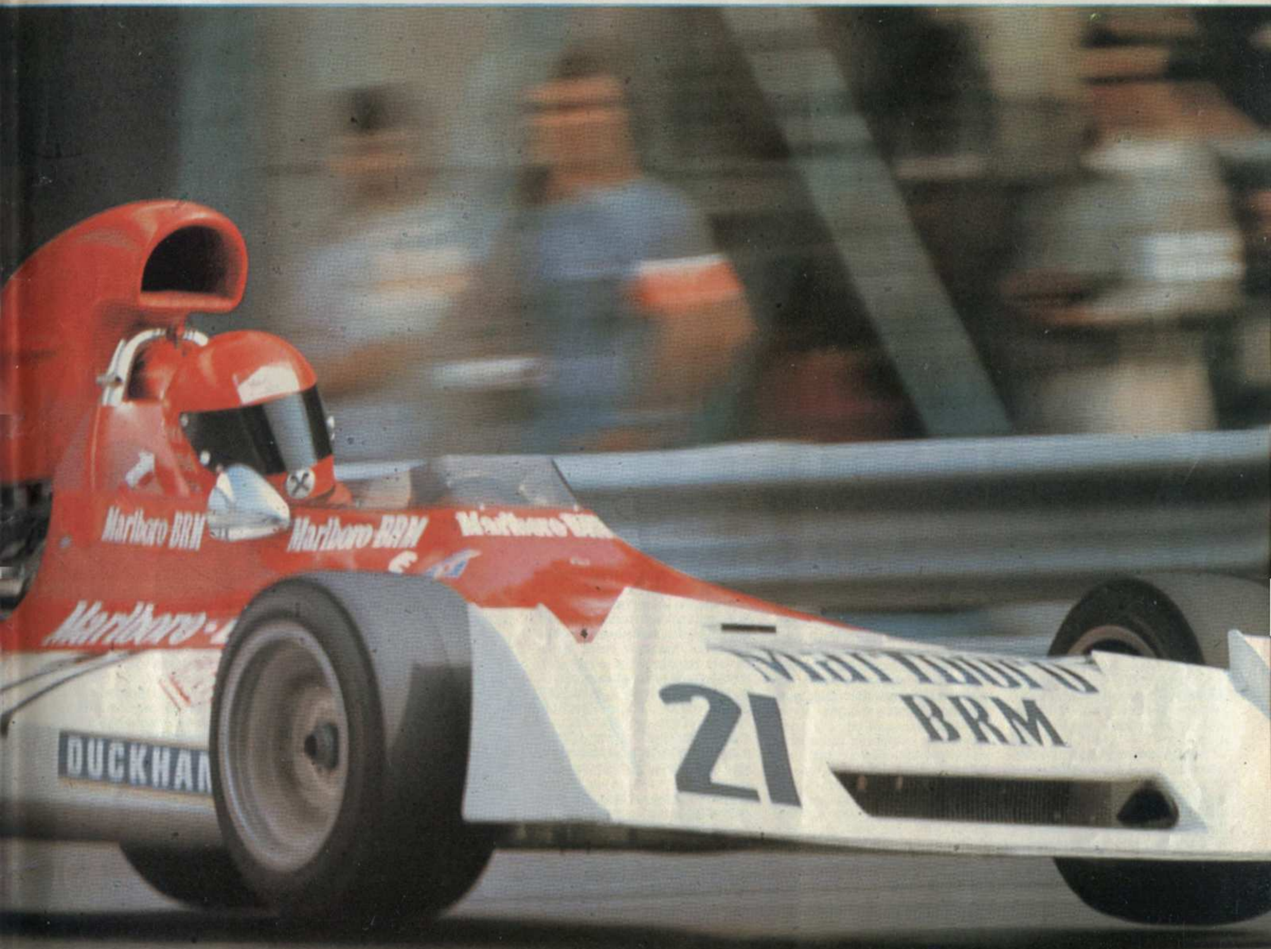
Nelle foto, esempi di lavoro. A sinistra il salto a Montecarlo ha fatto perdere aderenza alla JPS di Fittipaldi. Sotto, la BRM-Marlboro di Lauda alza molto la ruota interna: segno anche di barre di rollio molto dure
