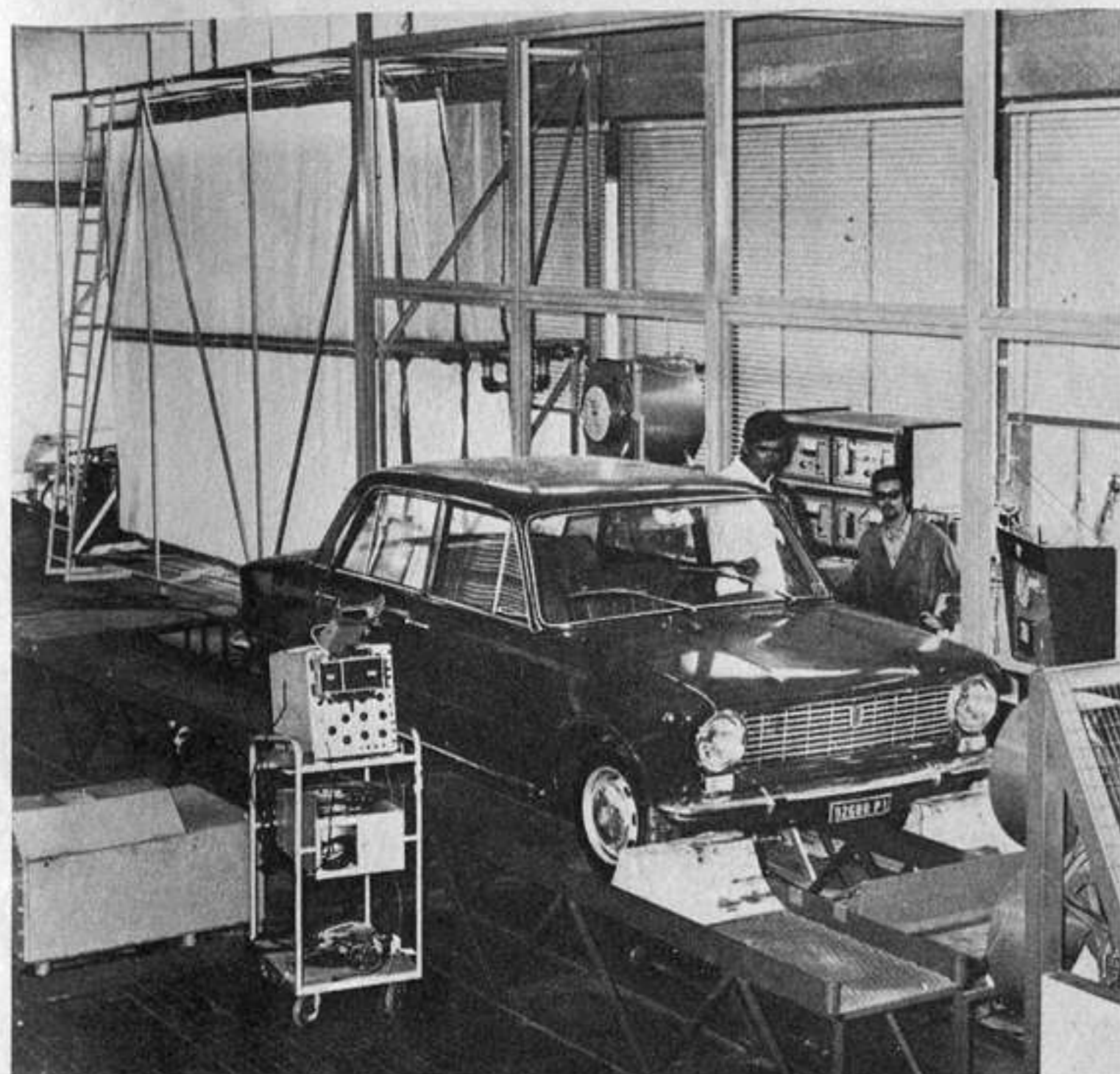
A sinistra, la Sport di Bizzarrini che è stata sviluppata nel laboratorio nella pineta di Tombolo. Sopra, una prova di inquinamento
