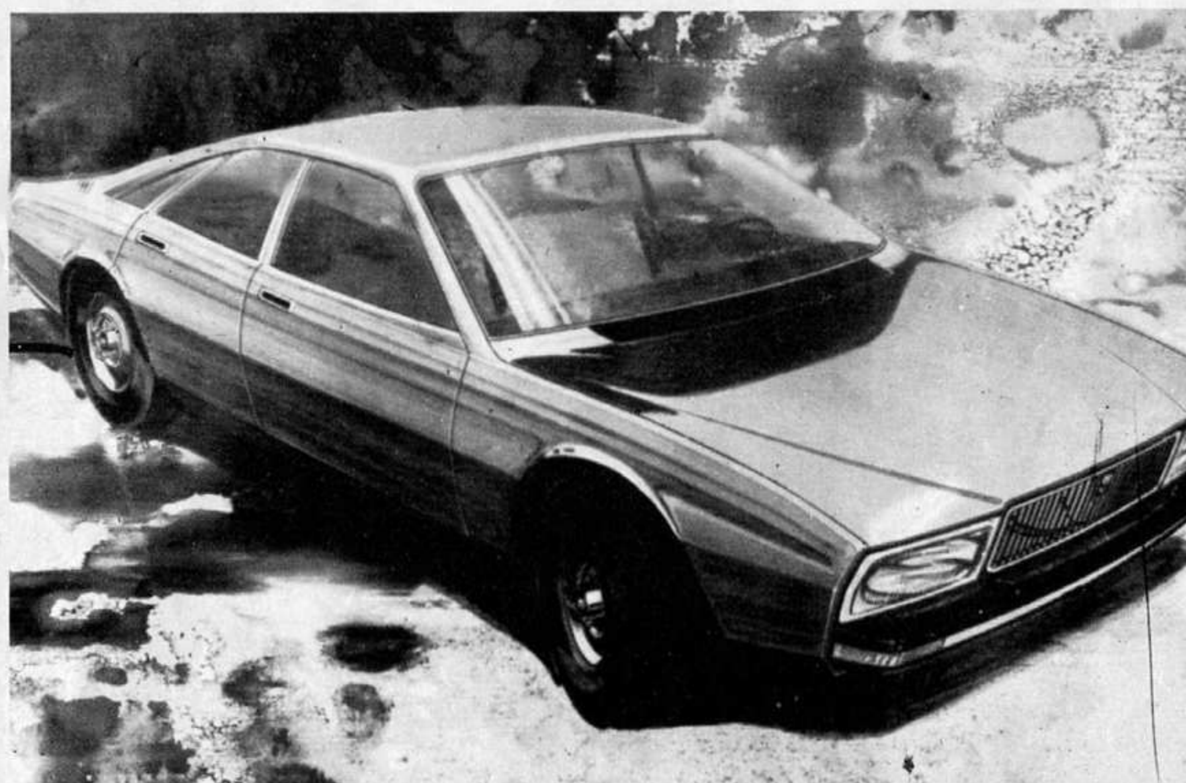
Qui sopra, in questo disegno l'aspetto della Jaguar speciale che Pininfarina porterà a Parigi. La vettura, che monta il motore a 12 cilindri sul pianale XJ a passo normale, si presenta come un lussuoso coupé a quattro porte e quattro comodi posti. Sotto: il prototipo Bertone su meccanica AUDI NSU RO 80. Un curioso quattro posti definito «a trapezio» grazie alla meccanica in senso longitudinale
