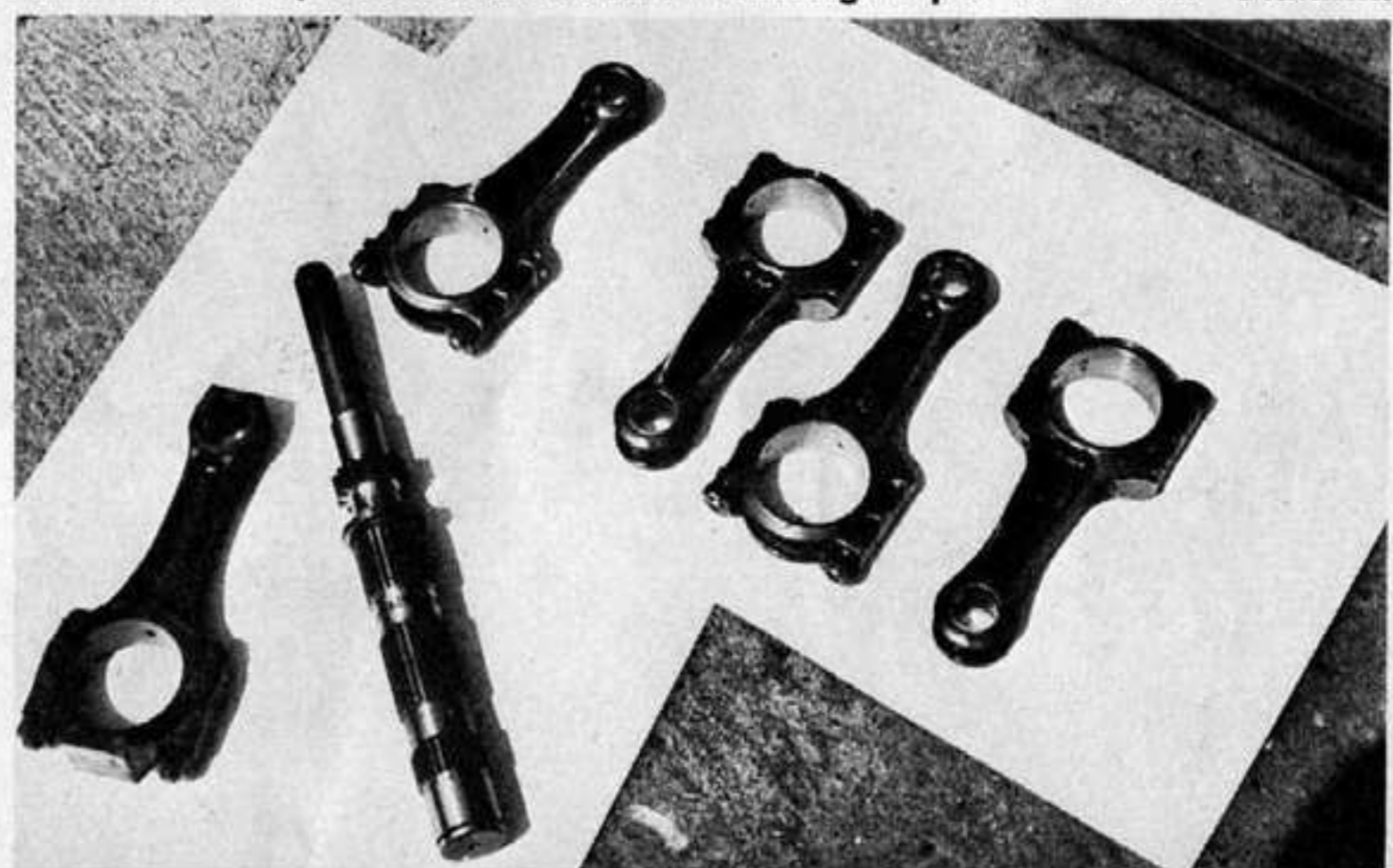
Sopra, un angolo delle officine Gianni, con un motore 126 in fase di preparazione. Sotto, le quattro bielle per la 128 NP confrontate a quella di serie, assieme all'alberino per la cinquemarce. A sinistra, uno dei passaruota anteriori omologati per la 128 NP Gianni
