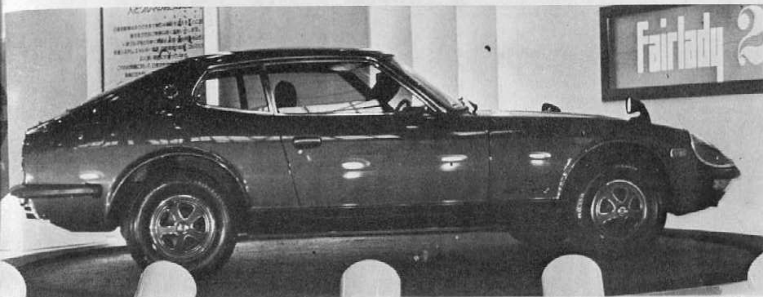
La versione 2+2 della nota Datsun-Nissan coupé, siglata ora 260 Z e dotata di un motore bialbero 2600 a 6 cilindri in linea. E' per gli Stati Uniti, dove già aveva molto successo la coupé 240 Z
