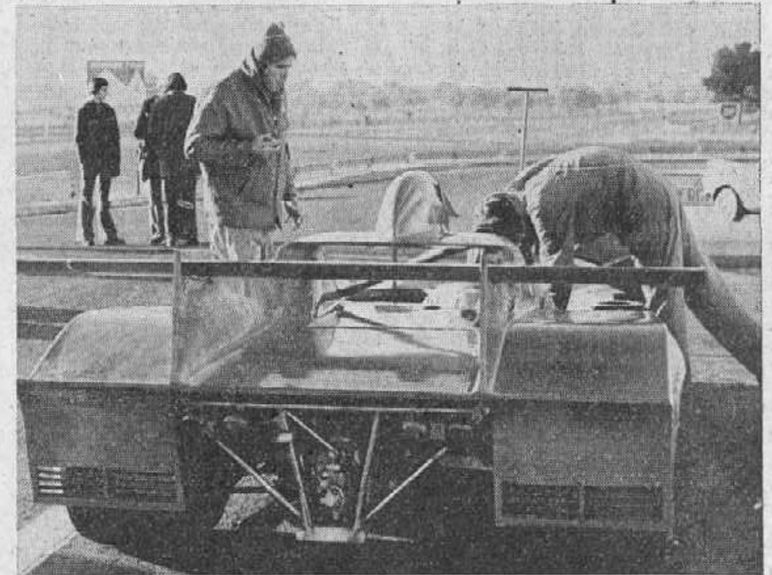
Ecco le linee posteriori della 312 P 1974, più bassa della precedente, con le pinnature verticali che sorreggono l'alettone regolabile
