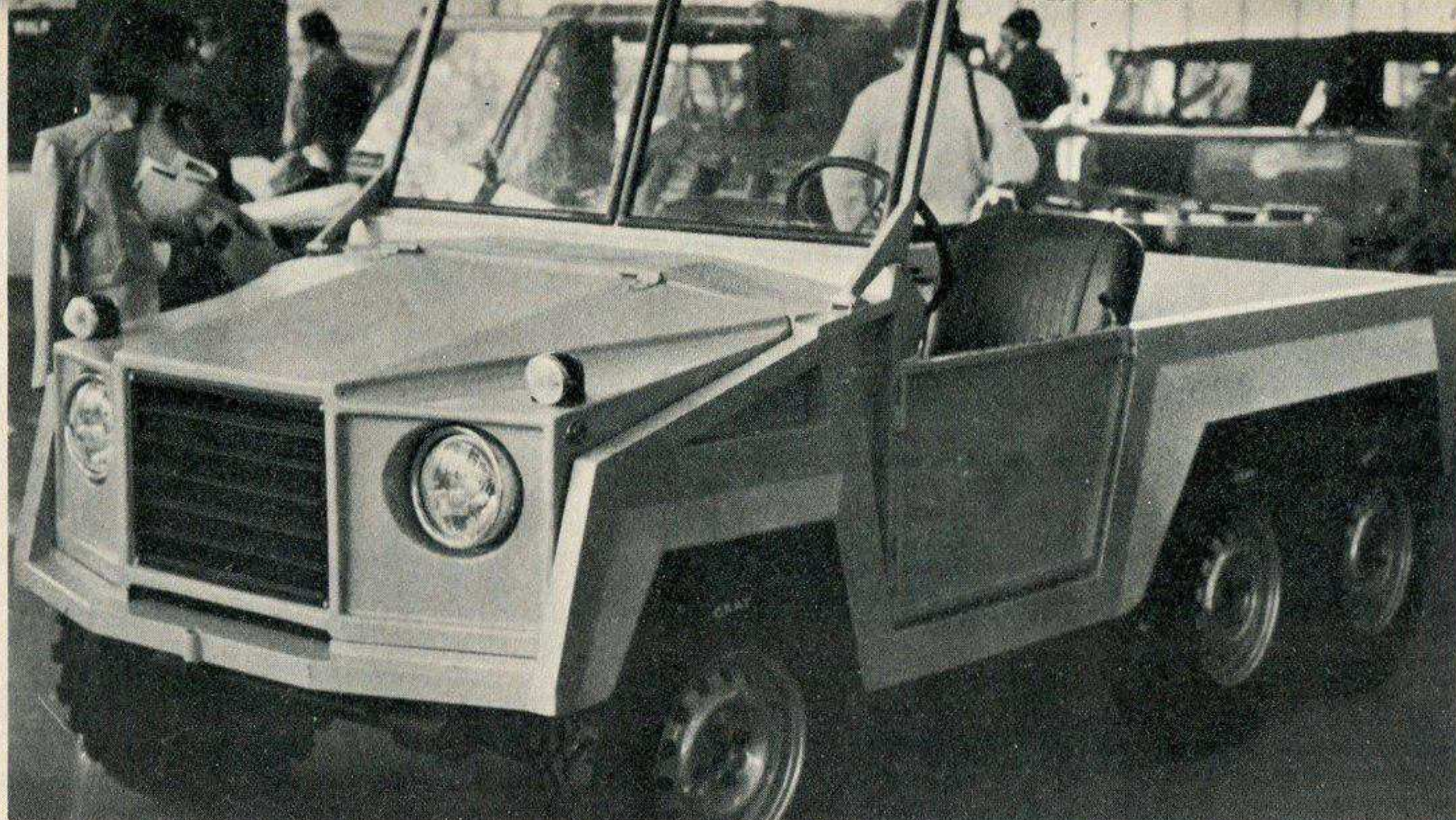
L'interessantissimo « Yeti » a tre assi, con tutte e sei le ruote motrici, che verrà commercializzato nei primi mesi di quest'anno. E' dotato del motore della Fiat 124. Costerà circa 2 milioni e mezzo
