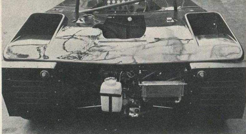
Qui sopra, in evidenza le feritoie posteriori dalle quali fuoriesce l'aria che ha attraversato i radiatori. A destra, senza la carenatura la linea anteriore della Gipsy, con il telaio a pannelli chiodati
