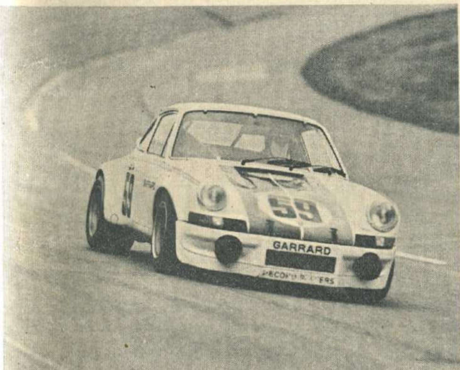
Questa è la vittoriosa Porsche Carrera 2.7 di Gregg-Haywood. La carenatura fa da spoiler e da contenitore del radiatore lubrificante
