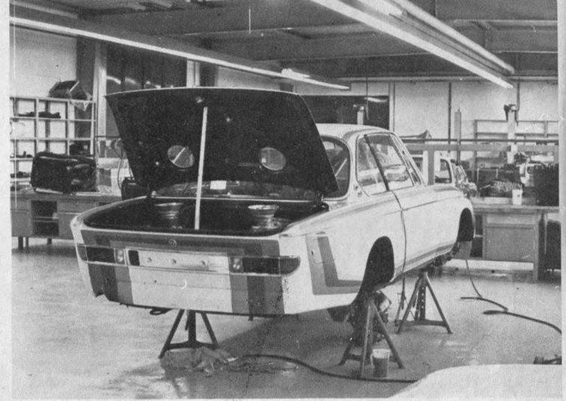
Nel cofano posteriore, spiccano i due fori per il sistema di riempimento automatico del serbatoio, che prevede la valvola di riflusso
